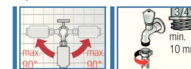
2. Ouvrez le robinet d'eau avec précaution et vérifiez l'étanchéité des points de raccordement.
