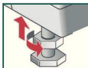
**Attention** : les contre-écrous des quatre pieds doivent être fermement vissés contre la carrosserie de l'appareil !
