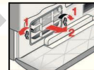
5. Luftkühler entfernen.
