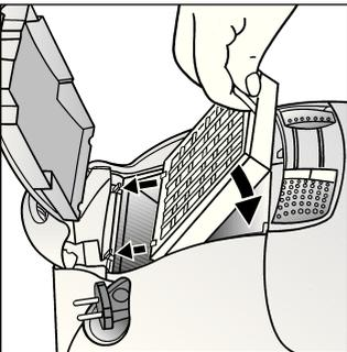
**Nach dem Aufsaugen feiner Staubpartikel, Motorschutzfilter durch Ausklopfen reinigen, evtl. HEPA-Filter austauschen.**
