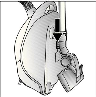
Zum Abstellen/Transportieren des Gerätes können Sie die Abstellhilfe an der Geräteunterseite benutzen. Gerät aufrecht hinstellen. Kunststoffrippe an der Bodendüse in die Aussparung an der Geräteunterseite schieben.
