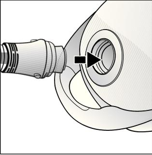
Saugschlauchstutzen in die Saugöffnung einrasten.
