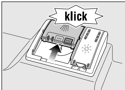
La cámara del detergente se abre automáticamente y en el instante adecuado, según el programa de lavado seleccionado.
