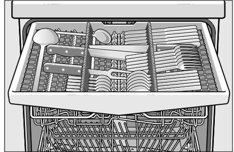
Según el modelo, los soportes laterales se pueden abatir para disponer de más espacio para colocar cubiertos de mayor tamaño en el lavavajillas. Las filas delanteras de ganchos se pueden abatir para colocar piezas de vajilla de asas anchas.
