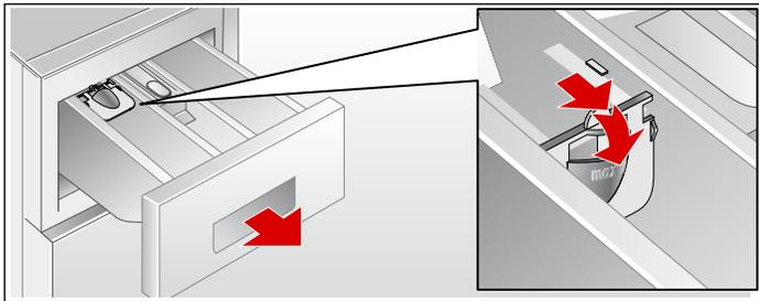
**AVIS :** N'utilisez pas le bac de détergent liquide avec des détergents de type à gel et des détergents en poudre ou pour des cycles avec pré-lavage et temps "terminer à".
