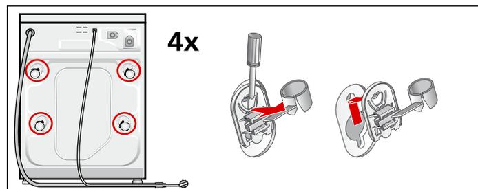
1. Retirez les quatre couvercles des trous des boulons de transport.
