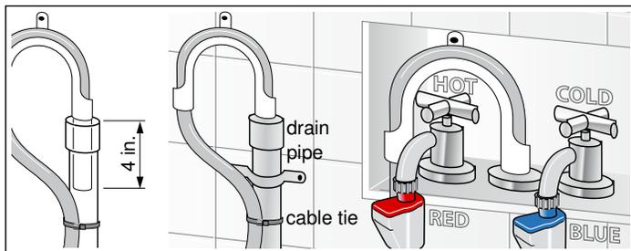
Fixez le boyau de drainage avec le coude fourni avec la laveuse.
