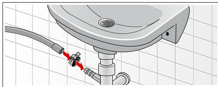
Fixez le boyau de drainage au siphon d'évier au moyen d'une agrafe de boyau de Ø 0,9 à 1,6 po (20 à 44 mm) (disponible dans une quincaillerie locale).
