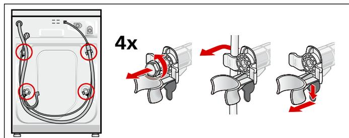
3. Placez des couvercles sur les trous des boulons de transport.
