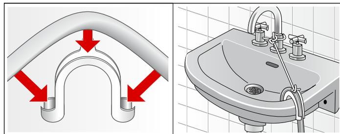
Fixez le boyau de drainage solidement dans le lavabo.
