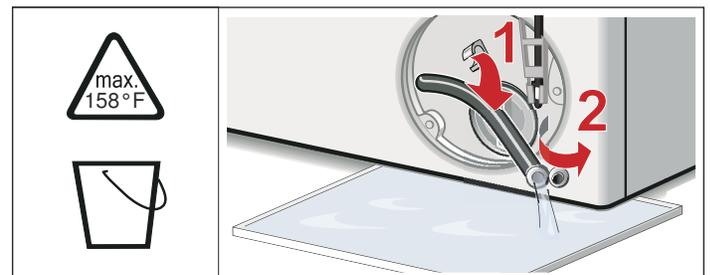
5. Utilisez le boyau de drainage escamotable situé dans l'ouverture d'accès de pompe pour drainer l'eau restante dans un contenant convenable (jusqu'à 5,3 gallons U.S./20 litres d'eau peuvent être drainés). Enlevez le capuchon d'étanchéité du boyau et reposez le boyau par dessus le côté du contenant et laissez l'eau se drainer complètement du tambour. Une fois terminé, remettez le capuchon d'étanchéité à l'extrémité du boyau et remettez le boyau dans son rangement.
