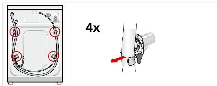
2. Desserrez et retirez les quatre boulons de transport. Retirez les douilles. Ôtez le câble d'alimentation des supports.
