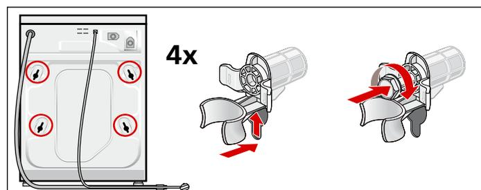
1. Chaque assemblage est composé d'une bague en plastique et d'un boulon qui se prolonge au travers des bagues. Dévissez le boulon jusqu'à ce que l'extrémité fileté soit en affleurement avec l'extrémité de la bague en plastique.
