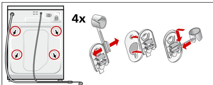
**AVIS :** Conservez les assemblages ensemble et rangez-les pour utilisation ultérieure, p. ex. pour le déplacement de la laveuse. Retirez les boulons de transport.
