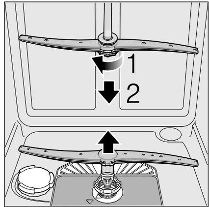
4. Sprüharme unter fließendem Wasser reinigen.
