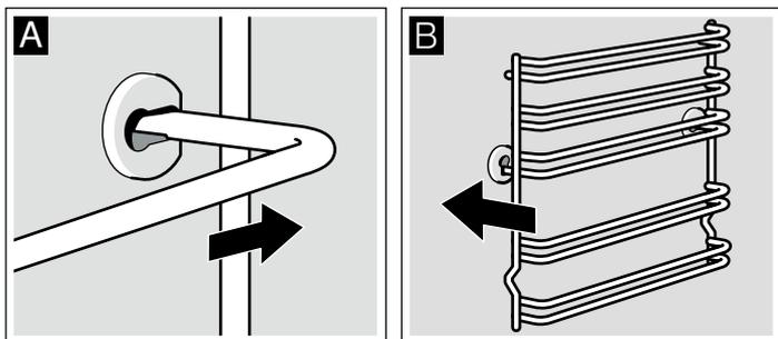
Les supports s'adaptent à droite et à gauche. Veillez à ce que la hauteur 1 et 2 soit en bas, comme sur la fig. B, et la hauteur 3, 4 et 5 en haut.
