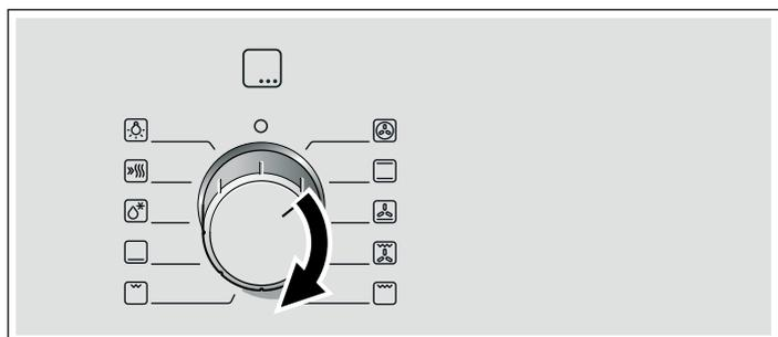
2. A l'aide du thermostat, régler la température ou la position gril.
