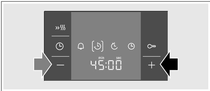
Le four se met en marche quelques secondes plus tard. La durée s'écoule visiblement dans l'affichage et le symbole
