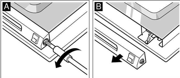
Veillez à ne pas fermer la porte du four tant que le recouvrement est enlevé. La vitre intérieure peut être endommagée.
