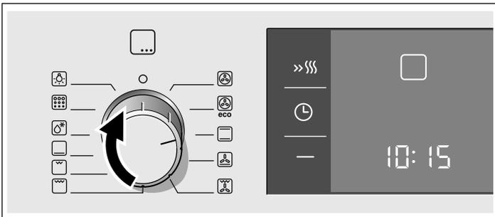
2. A l'aide du thermostat, régler la température ou la position grill.
