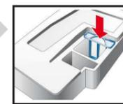
5. Задвиньте резервуар для конденсата обратно, так чтобы он зафиксировался.
