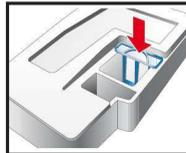
5. Задвиньте резервуар для конденсата обратно, так чтобы он зафиксировался.
