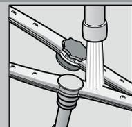
očistite razpršilne šobe pod tekočo vodo (če je potrebno z zobotrebčem) ....
