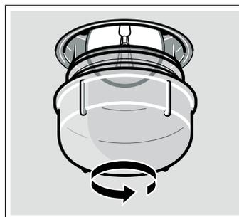
3. Remplacer l'ampoule par un modèle identique.
