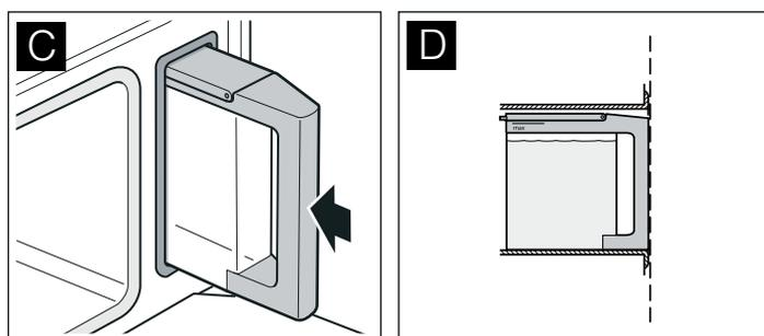
O reservatório tem de estar à face da caixa do reservatório (figura D).
