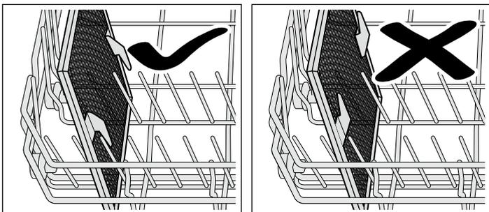
Lave o filtro de gorduras sempre que o aparelho fique muito sujo após um cozinhado, com uma solução de água quente e detergente ou na máquina de lavar loiça.
