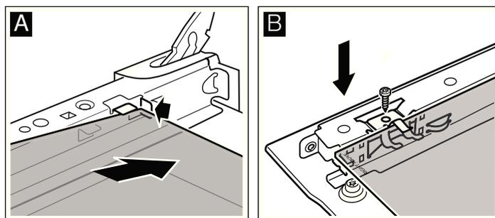
3. Engager la vitre du dessus vers l'arrière en l'inclinant. La face lisse doit être à l'extérieur.
