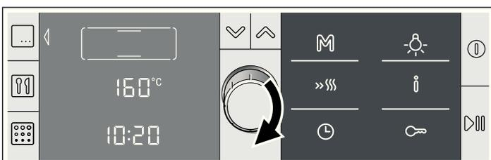
2. Commuter à la température au moyen de la touche ∨. Les parenthèses sont placées à gauche et à droite de la température ou de la position gril.
