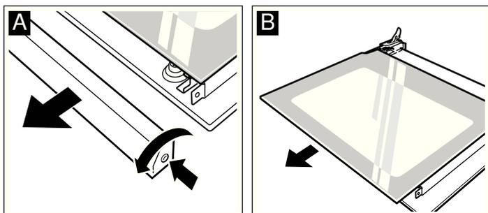
4. Dévisser les crochets à droite et à gauche. Lever la vitre et retirer les fixations de la vitre (fig. C). Enlever la vitre.
