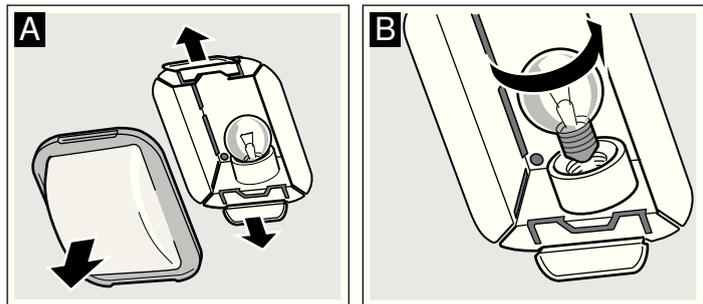
4. Remettre en place le cache en verre. Ce faisant, l'insérer d'un côté et l'appuyer fermement de l'autre côté. Le verre s'encliquete.
