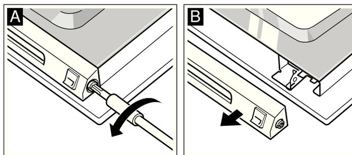
Veillez à ne pas fermer la porte du four tant que le recouvrement est enlevé. La vitre intérieure peut être endommagée.
