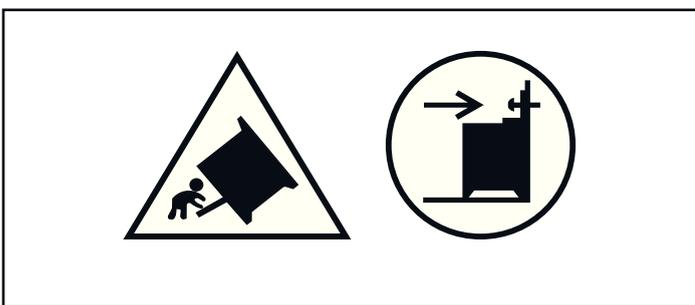
**Avertissement** : Afin d'éviter un basculement de l'appareil, il convient de mettre en place une protection anti-renversement. Veuillez lire la notice de montage.
