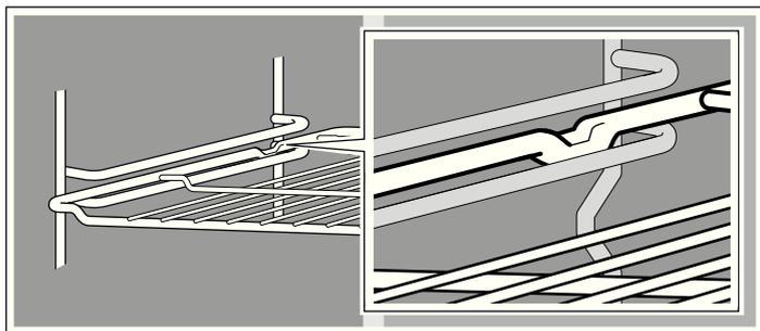
**Remarque :** Lorsque l'accessoire devient chaud il peut se déformer. Une fois refroidi, la déformation disparaît. Cela n'influe en rien sur le fonctionnement.
