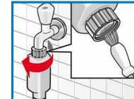
**E/ou** em modelos Standard e Aqua-Secure: Retirar a mangueira na parte traseira do aparelho, extrair o filtro de rede com a pinça e limpá-lo.
