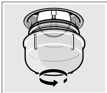
3. Remplacer l'ampoule par un modèle identique.
