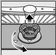
Odvrti cilindar mrežice ukloniti sustav za filtriranje ...
