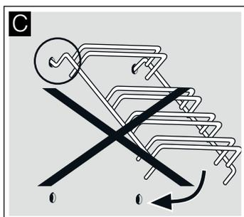
2. les deux crochets doivent être complètement insérés dans les trous situés dans le haut de la paroi. Déplacez ensuite le support vers le bas, lentement et avec précaution, et insérez les crochets inférieurs (Figure D).
