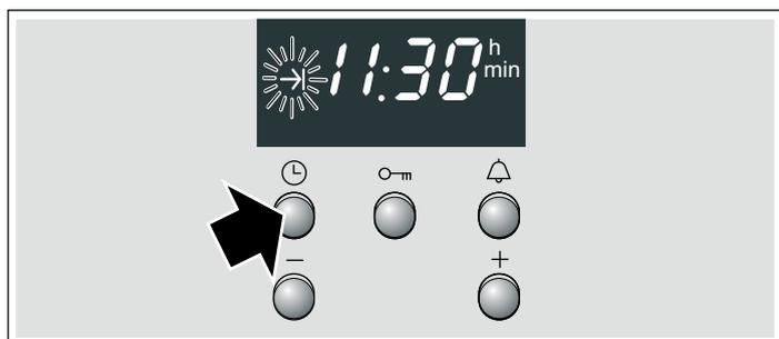
6. La touche + permet de retarder la fin de la cuisson. Le réglage est mémorisé au bout de quelques secondes. La fin de la cuisson est visible sur l'affichage jusqu'à la mise en marche du four.
