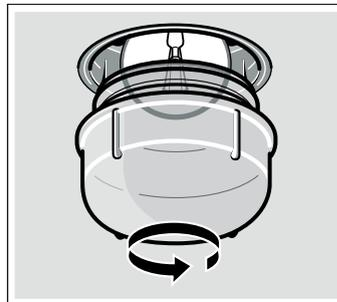
3. Remplacer l'ampoule par un modèle identique.
