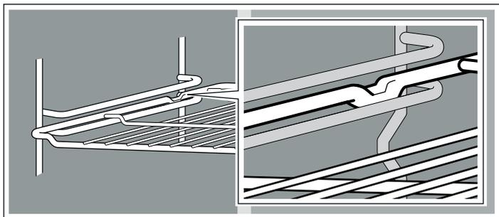
**Remarque :** L'accessoire peut se déformer sous l'effet de la chaleur. Une fois refroidi, l'accessoire reprend sa forme initiale. Cela n'a pas d'incidence sur son fonctionnement.
