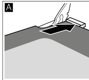
2. Installez le couvercle supérieur sur la porte du four et appuyez. Faites attention à ce que les encoches sur les côtés s'engagent correctement.
