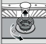
Rodar o filtro cilíndrico
