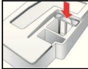
! Utilize a máquina de secar apenas com o filtro inserido!
