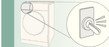
A limpeza automática da máquina de secar produz cliques.
