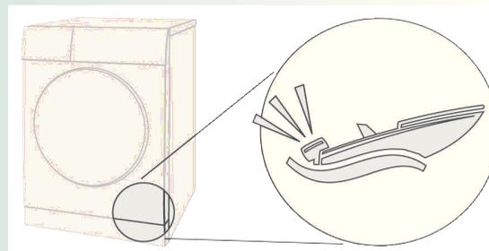
De vez em quando, o compressor da máquina de secar emite um zumbido.
