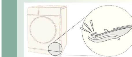
De vez em quando, o compressor da máquina de secar emite um zumbido.
