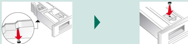
Condenswaterreservoir 180° draaien en op de kop leggen en de daar geplaatste plug verwijderen.
