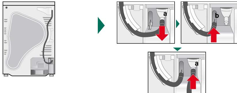
Uitleverstoelstand van de droogautomaat: de slang is voor de afvoer van het condenswater in het condenswaterreservoir op de aansluiting bevestigd.
