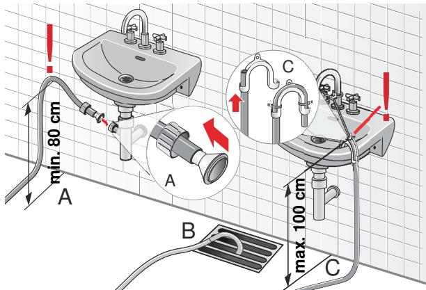
De afvoerslang afhankelijk van de aansluitsituatie (**A**, **B** of **C**) met de rest van de toebehoren monteren. Let op de maten!
