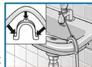
**Remarque** : veillez à retirer le bouchon de l'orifice d'écoulement. Pendant la vidange, vérifiez que l'eau s'écoule suffisamment vite par l'orifice. L'extrémité du flexible d'évacuation ne doit en aucun cas être immergée dans l'eau de vidange. Dans le cas contraire, l'eau de vidange risque de refluer dans le lave-linge.
