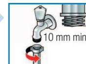
2. Ouvrez le robinet avec précaution et vérifiez l'étanchéité des points de raccordement.
