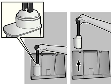
**Info :** le rinçage du filtre a activé le réglage pour l'affichage du changement de filtre. Vous trouverez des informations détaillées sur le filtre d'eau dans les Instructions relatives au filtre ci-jointes.
