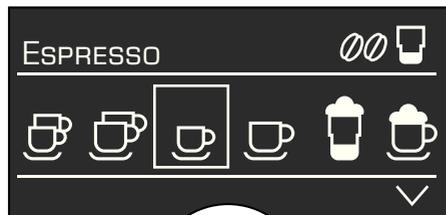
Nella riga di stato **5a** del display **5** viene visualizzato il nome del tipo di bevanda e il valore impostato per l'intensità, ad esempio  $\infty$  e per la quantità, ad esempio  $\text{☕}$ . La riga di selezione **5b** rappresenta i simboli per la selezione delle bevande. Le frecce nella riga di navigazione **5c** indicano in quale direzione sono disponibili ulteriori livelli di menu.
