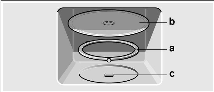
**Nota:** Utilize o aparelho apenas com o prato rotativo colocado. Certifique-se de que está correctamente encaixado. O prato rotativo pode rodar para a esquerda ou para a direita.
