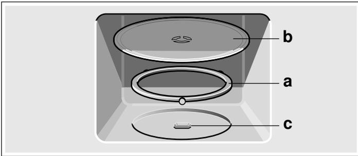
**Nota:** Utilizar el aparato solo cuando el plato giratorio esté colocado. Asegurarse de que queda correctamente enclavado. El plato giratorio puede girar hacia la izquierda o hacia la derecha.
