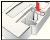
5. Réintroduisez le réservoir d'eau de condensation et poussez-le jusqu'à ce qu'il s'enclenche.
