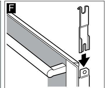
4. Abdeckung aufsetzen und anschrauben. Lässt sich die Abdeckung nicht anschrauben, prüfen ob die Scheiben richtig in der Halterung sitzen.
