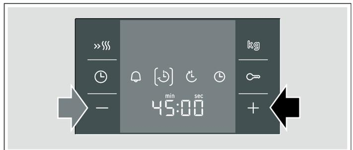
Nach wenigen Sekunden startet der Backofen. In der Anzeige läuft die Dauer sichtbar ab und das Symbol [
