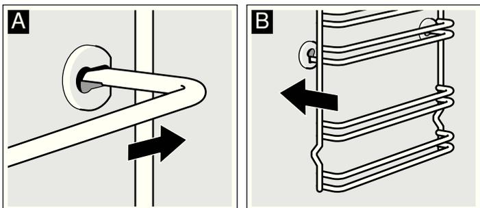
Les supports s'adaptent à droite et à gauche. La courbure doit toujours être en bas.
