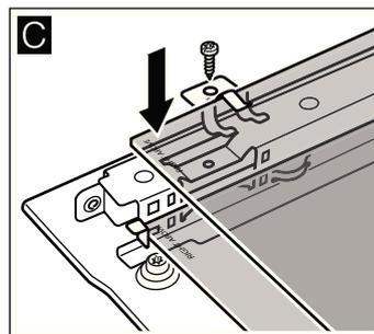
4. Engager la vitre du dessus vers l'arrière en l'inclinant. La face lisse doit être à l'extérieur.
