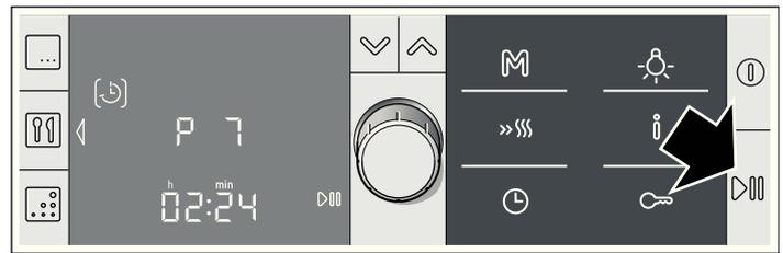
Das Programm startet. Die Dauer [02:24] läuft sichtbar in der Uhranzeige ab.
