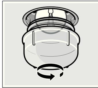
3. Lampe durch den gleichen Lampentyp ersetzen.
