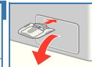
2. Wasserrinne ausklappen und Behälter mit ausreichendem Fassungsvermögen unterstellen.
