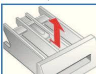
**i** Waschmittelschublade offen lassen, damit Restwasser abtrocknen kann.
