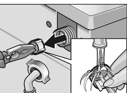
Si la lavadora no recibe el agua necesaria, eliminar la presión de agua del tubo de alimentación:
