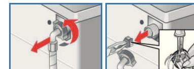
6. Raccordez le flexible et vérifiez l'étanchéité du branchement.
