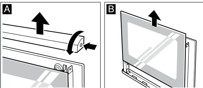
4. Haltefedern rechts und links aufschrauben und entfernen (Bild C). Scheibe schräg nach oben herausnehmen.
