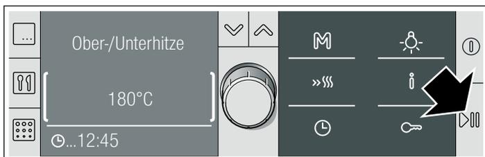
Die Einstellung ist übernommen. Der Backofen ist in Warteposition ⌚... . In der Statuszeile wird die Endezeit angezeigt. Wenn der Betrieb startet, läuft in der Statuszeile die Dauer sichtbar ab.
