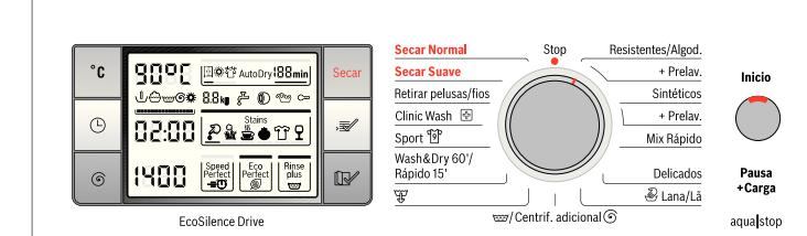
**i** Mando selector de programas para conectar y desconectar la máquina, así como para seleccionar el programa de lavado o secado que se desea ejecutar.
