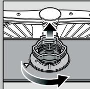
Przekręcić sito cylindryczne, wyjąć system filtrujący ...
