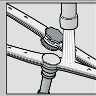
dizne za raspršivanje očistiti pod mlazom tekuće vode (eventualno uz pomoć čačkalice za zube) ...
