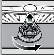
Odvrti cilindar sita, sistem sita izvaditi ...
