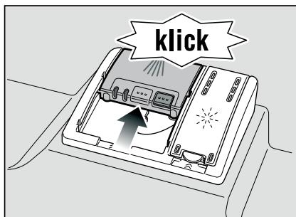
La cámara del detergente se abre automáticamente y en el instante adecuado, según el programa de lavado seleccionado.
