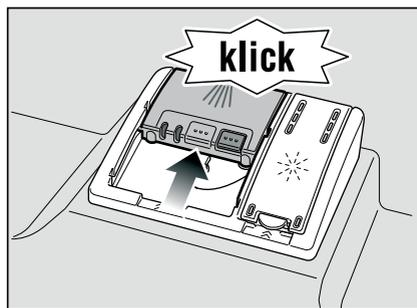
Komora za sredstvo za pranje se, ovisno o programu, otvara automatski u najpovoljnijem trenutku. Praškasto ili tekuće sredstvo za pranje se raspoređuje u aparatu i otapa, tableta pada u prihvatnu posudu za tablete te se tamo dozirano otapa.
