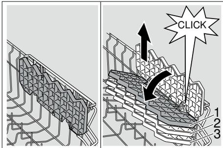
\* Ovisno o modelu moguće je podesiti 3 različite visine. Za to etažer prvo trebate postaviti okomito te ga povući nagore, potom iz nakošenoga položaja povući nadalje, podesiti na željenu visinu (1, 2 ili 3) i utaknuti ga u ležište (začut će te "klik").
