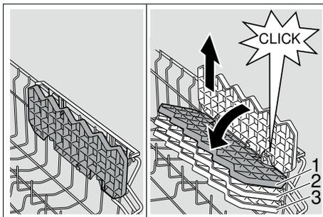
\* Dependendo do modelo, é possível um ajuste de três posições em altura. Para isso, posicionar, primeiro, a prateleira em posição vertical e puxar a mesma para cima, depois, ligeiramente inclinada, deslocar para baixo e para a altura pretendida (1, 2, ou 3) e deixar que encaixe com um clic audível.
