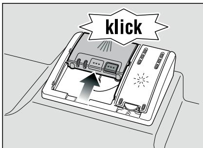
Komora za sredstvo za pranje se, zavisno od programa, otvara automatski u optimalnom trenutku. Praškasto ili tečno sredstvo za pranje se raspoređuje u aparatu i rastvara, tableta pada u prihvatu posudu za tablete pa se tamo dozirano rastvara.
