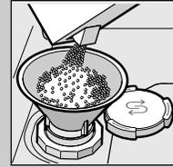
Spezialsalz einfüllen (nie Reiniger einfüllen!).
