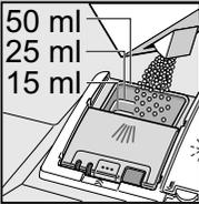
Reiniger nur in trockene Reinigerkammer einfüllen.
