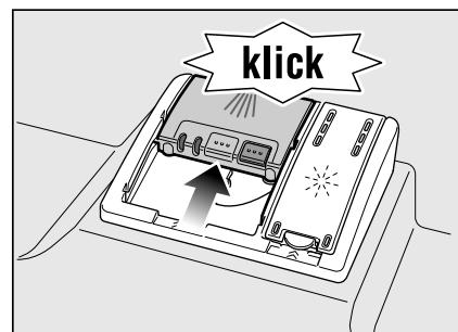
La cámara del detergente se abre automáticamente y en el instante adecuado, según el programa de lavado seleccionado. El detergente en polvo o líquido se distribuye por el aparato, disolviéndose en el agua. La pastilla cae dentro del aparato, disolviéndose allí.
