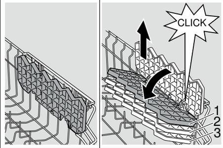
\* Je nach Modell ist eine 3-fache Höhenverstellung möglich. Dafür die Etageren zuerst senkrecht stellen und nach oben ziehen, dann, leicht schräg gestellt, nach unten auf die gewünschte Höhe (1, 2, oder 3) schieben und mit einem hörbaren Klick einrasten lassen.
