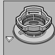
Kierrä siiviläjärjestelmä kiinni
