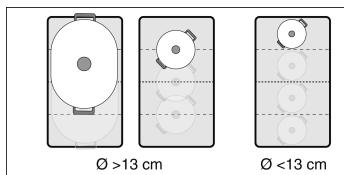
Wanneer twee pannen gebruikt worden met een verschillende maat of die niet uit hetzelfde materiaal bestaan, kunnen bepaalde geluiden of trillingen optreden die de correcte werking van de zone niet in de weg staan.
