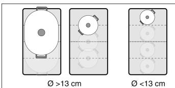
Die Kochzone besteht aus zahlreichen Induktoren, die unabhängig voneinander gesteuert werden. Ist die Kochstelle in Betrieb, schalten sich die Induktoren automatisch aus, auf denen sich kein Kochgefäß befindet.
