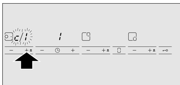
5. Appuyez à nouveau sur le symbole
