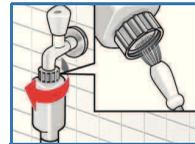
5. Schlauch vom Wasserhahn abnehmen. Sieb mit einer kleinen Bürste reinigen.
