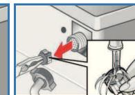
**und/oder** bei Modellen Standard und Aqua-Secure: Schlauch an der Geräterückseite abnehmen, Sieb mit Zange herausnehmen und reinigen.
