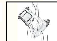
4. Filter einsetzen und bis zum Anschlag eindrehen.
