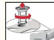
3. Filter unter fließendem Wasserstrahl reinigen.
