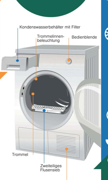
**! Während des Trocknens Kondenswasserbehälter nicht herausziehen/entleeren**
