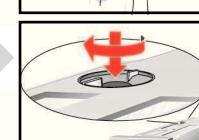
5. Posodo za kondenzacijsko vodo potisnite v stroj, tako da se zaskoči.
