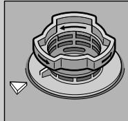
Avvitare il sistema di filtraggio. **RISPETTARE IL RIFERIMENTO!**
