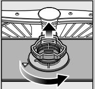
Ruotare il cilindro filtro, rimuovere il sistema di filtraggio ...
