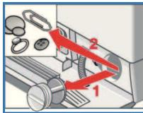
4. Limpar o espaço interior, rosca da tampa da bomba e a estrutura da bomba.
