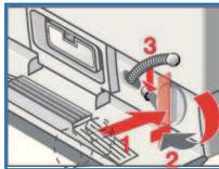
5. Voltar a montar e aparafusar a tampa da bomba. O punho está em posição vertical. Inserir a mangueira de esvaziamento no dispositivo de fixação.
