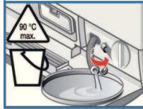
3. Desaparafusar com precaução a tampa da bomba (Restos de água). Remover corpos estranhos, incrustações e algodão (a roda de pás da bomba de esgoto tem que rodar sem impedimentos).
