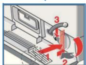
5. Voltar a montar e aparafusar a tampa da bomba. O punho está em posição vertical. Inserir a mangueira de esvaziamento no dispositivo de fixação.
